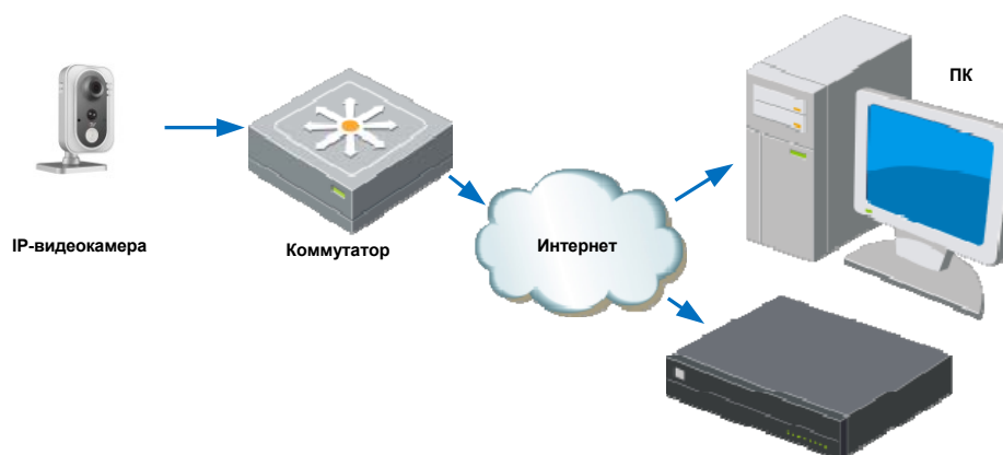
Рис. 3.1. Доступ к IP-видеокамере через локальную сеть
